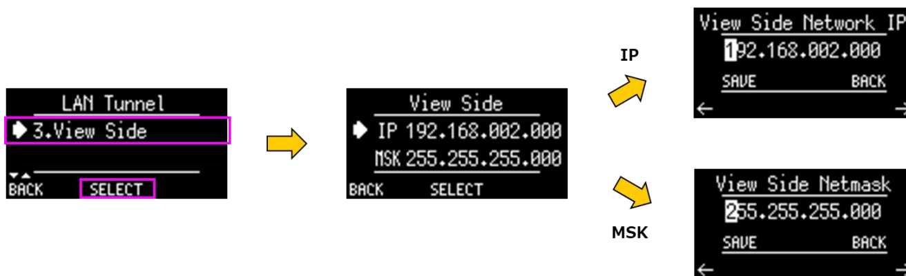
図 3-41 View Side(LAN Tunnel)
