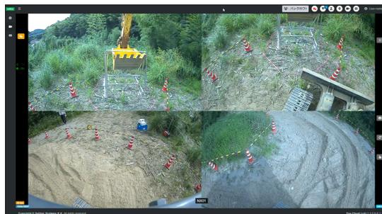
超遠隔操縦実験の様子(左:実機、右:遠隔操作卓映像)
