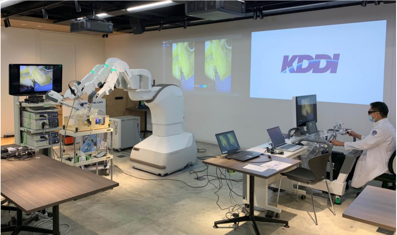
<5G SA と MEC によるロボット操作と複数モニターへの低遅延映像伝送の様子>
